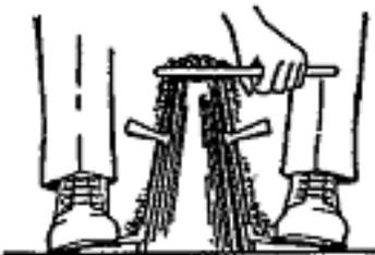
4. Utilisez la tige d'acier pour enlever l'excédent de béton au sommet du cône afin que ce dernier soit plein à ras bord. Nettoyez le surplus de béton qui se trouve à la base du cône.
